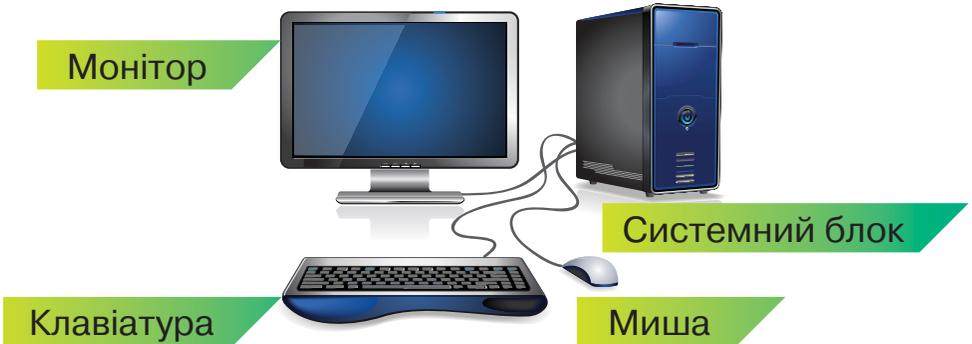
До **системного блока** підключають монітор, клавіатуру, мишу та інші пристрої.
